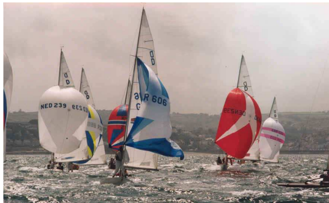
plusieurs coupes de spinnaker (radiales ou à lés horizontaux)
